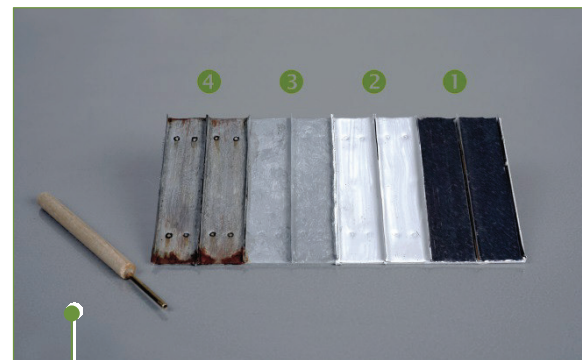
Die fertigen Bahnen wurden mit doppeltem Klebeband auf der Trägerplatte fixiert. 1 zeigt den Rohzustand, 2 die grundierete Bahn, bei 3 belebt etwas Bronze wieder den metallischen Charakter und 4 zeigt die fertigen Bahnen. Links der Prägestempel für die Auerbuckel.
