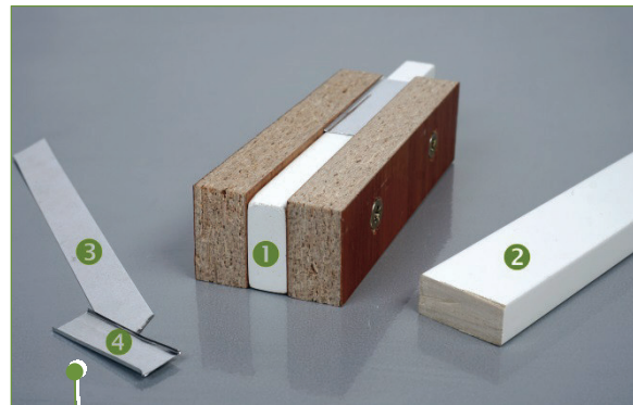
Aus Holzleistenstücken besteht die Form zum Falzen der Blechbahnen: 1 und 2 sind 10 mm breit. Entsprechende Breite hat die fertige Bahn 4, die aus einem 12 mm breiten Alustreifen 3 entstanden ist, die Ränder stehen 1 mm hoch.
